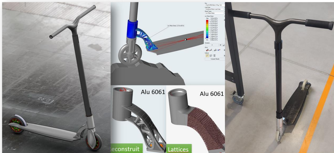
Figure 1 : Détails de la conception d'une trottinette
